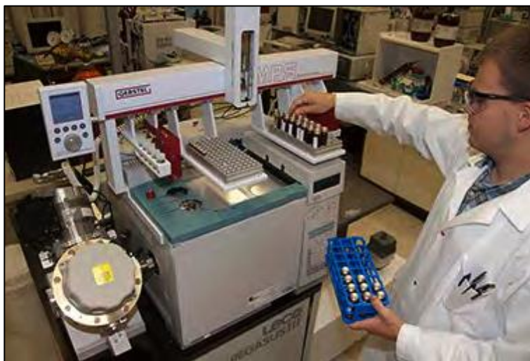
Figure 1. Chromatographe en phase gazeuse couplé à un spectromètre de masse de type Temps de vol ( Time-of-flight ), équipé d'un microextracteur en phase solide (Photo : Léonard Pigeon).
