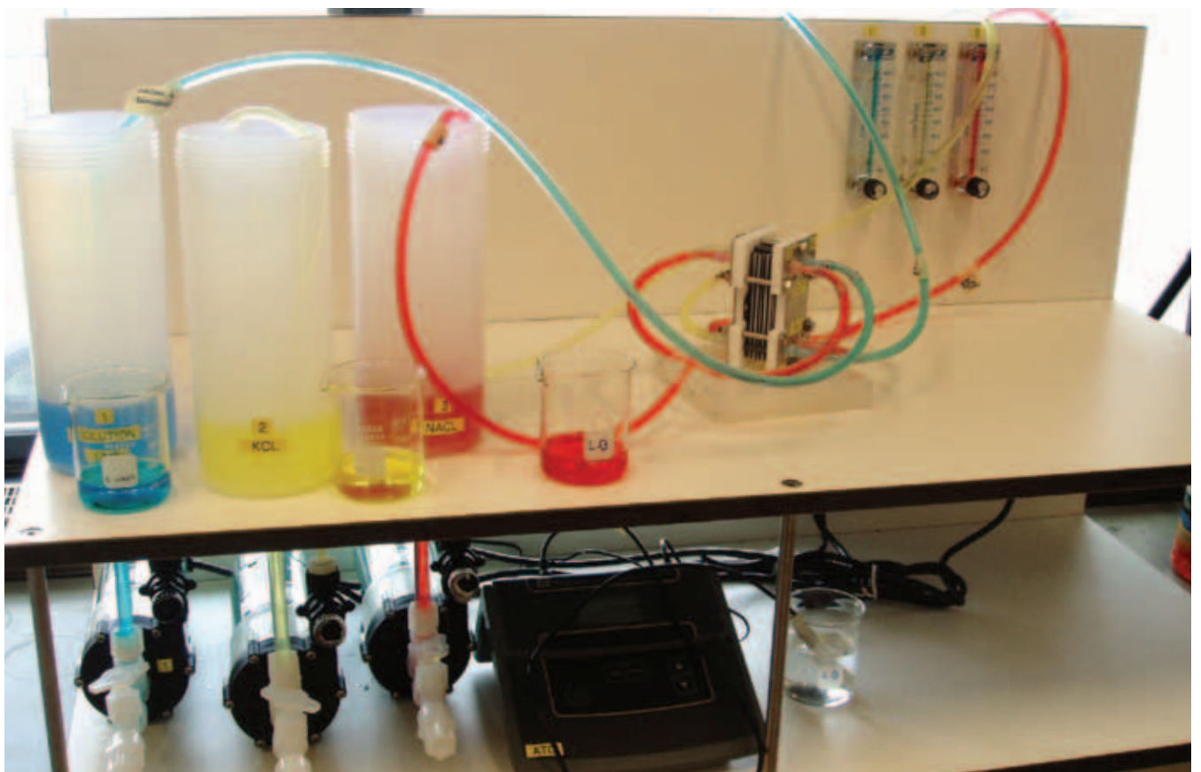
Ce prototype parvient, en quatre heures, à récupérer jusqu'à 80 % de certaines molécules bioactives présentes dans le bioréacteur.
